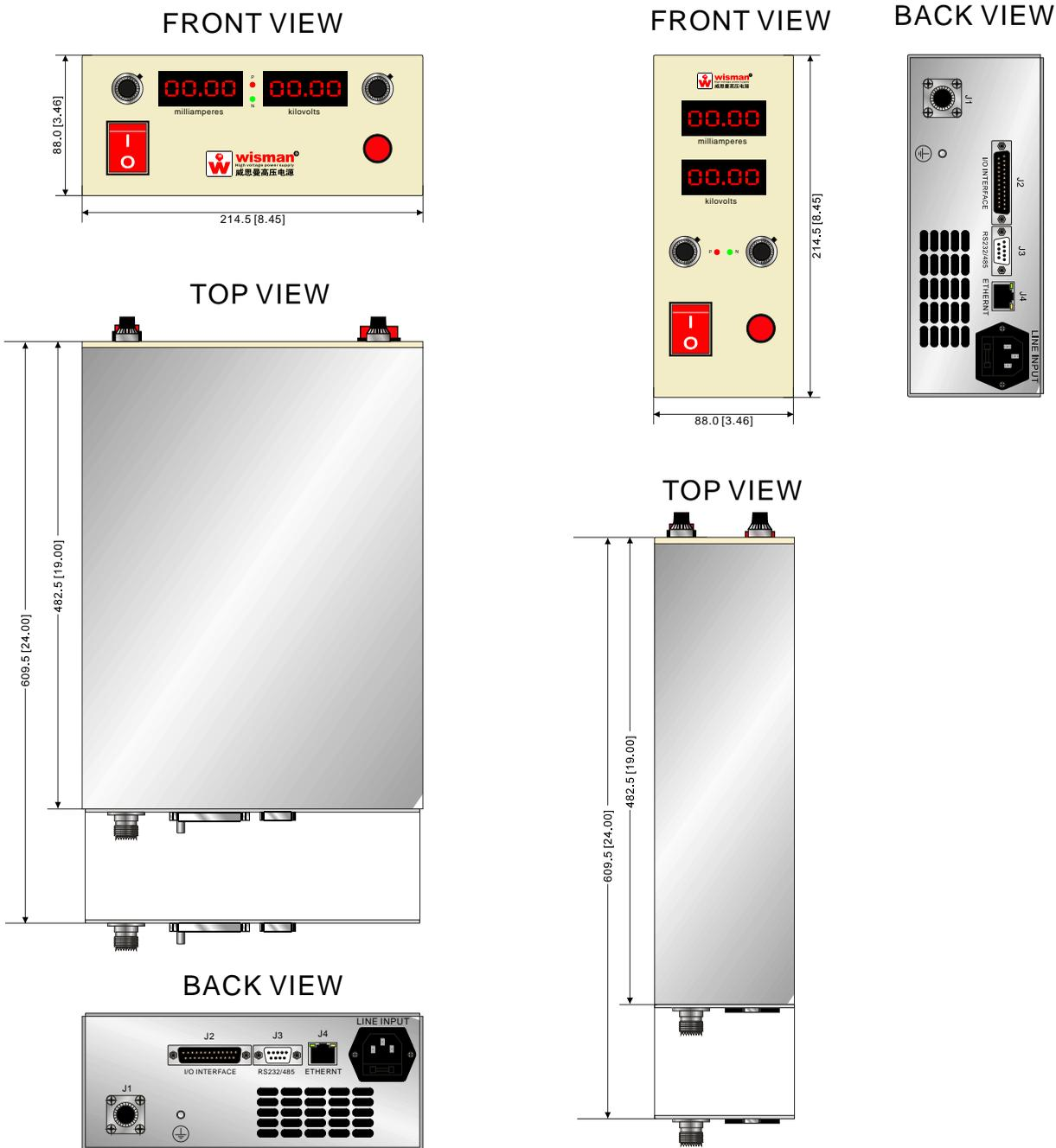
高压输出1~70kV时机箱长度为482.5mm
